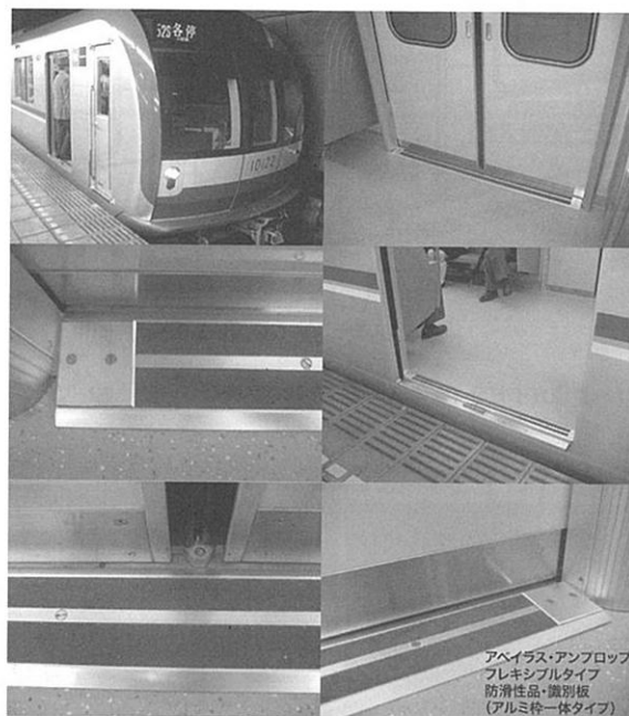
図3.8 筆者が研究開発過程でかわった高度防滑性床材である高硬度石英成形板「アベイラス・アンフロップ」の鉄道車輛ドア下床材への応用事例(東京メトロ有楽町線・副都心線用10000系の例) [写真提供:株式会社ドベル]
