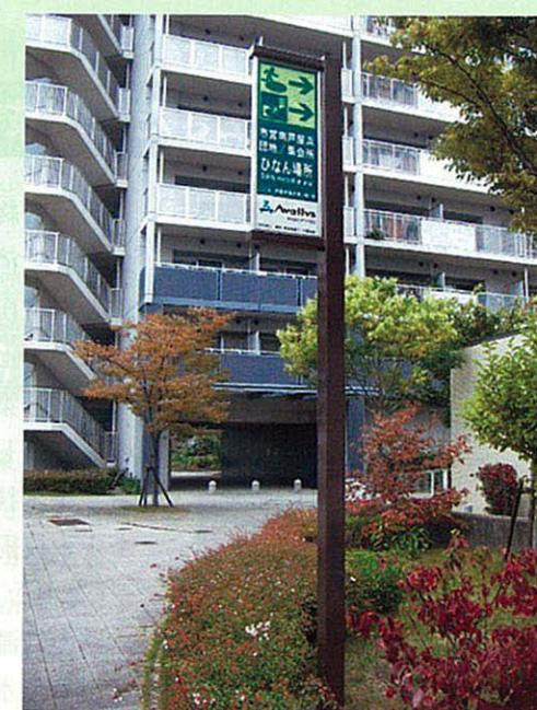
写真2 芦屋市蓄光式避難標識設置例
